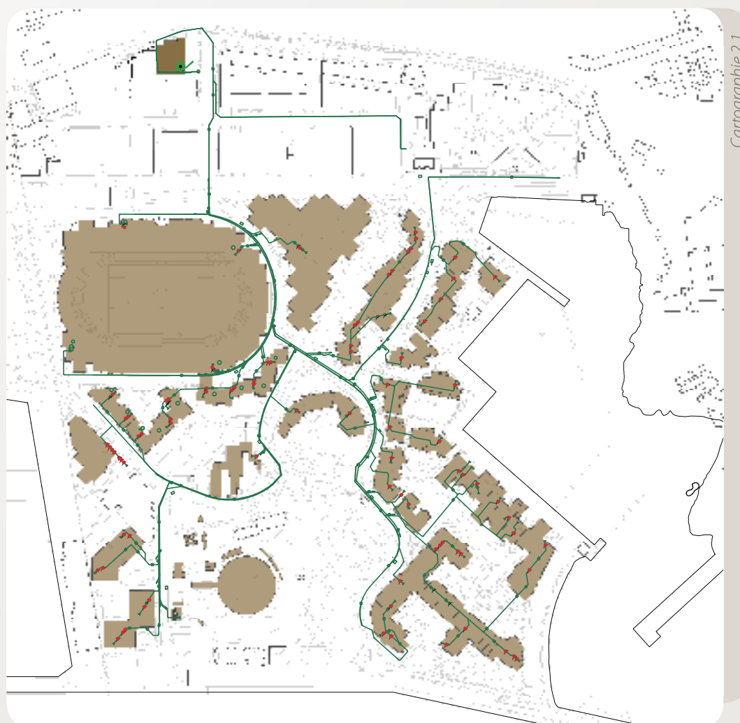
Réseaux de collecte pneumatique des ordures ménagères du quartier Fontvieille.
